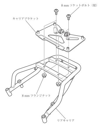
4) 図のように小組みしたリアキャリアを取り付ける。
