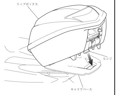
3) 図のようにレバーを下げヒンジを固定し、キーを施錠する。
