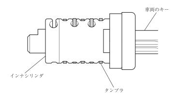
9) 図のようにインナシリンダをキーシリンダに差し込む。 ・スムーズにインナシリンダが回ることを確認する。
