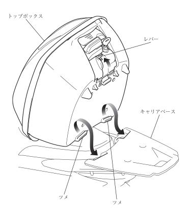
2) 図の位置にトップボックスのヒンジを取り付ける。
