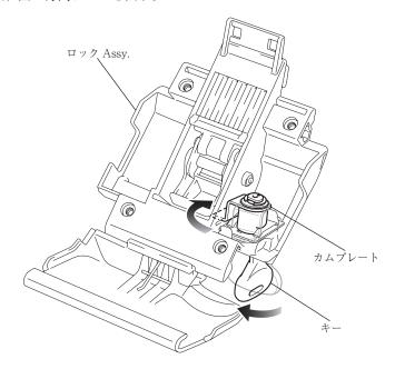
4) 図のようにロック Assy. の端をトップボックスの穴に差し込む。
