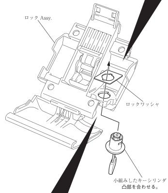
図のようにキーシリンダの凸部をロック Assy. の切り欠き部に合わせ、スプリングを取り付ける。 凸部 キーシリンダ スプリング 切り欠き部 ロックワッシャ
