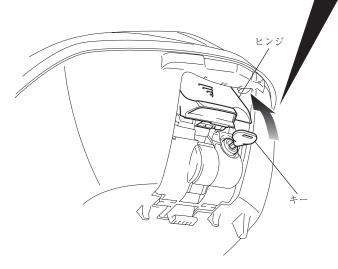
2) 図のようにヒンジの上部を手前に倒し、リッドを開ける。
