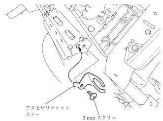
2) 図のようにアクセサリソケットハーネスにダミーカプラを取り付ける。
