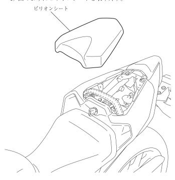
2) 図のようにシートを取り外し、バッテリケーブル (-) を取り外す。
