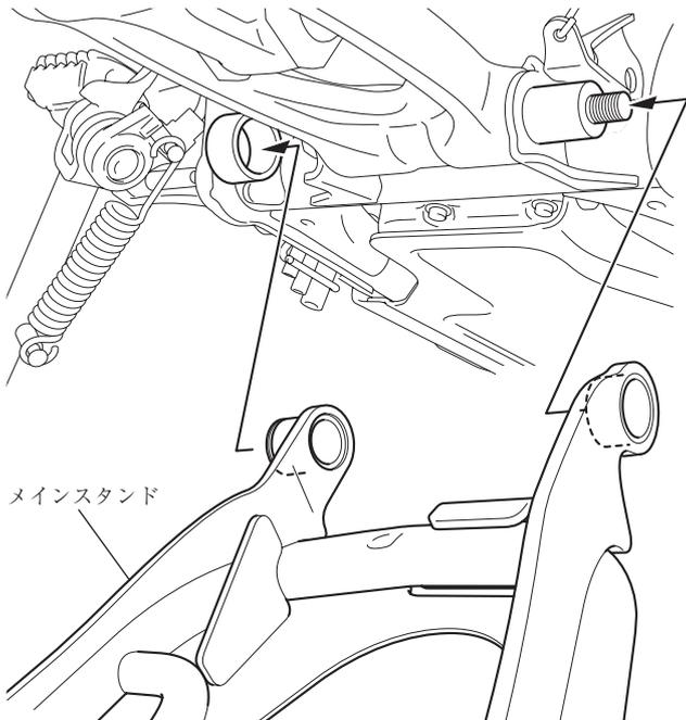
6) 取り外しの逆手順で取り外したナットを取り付ける。
