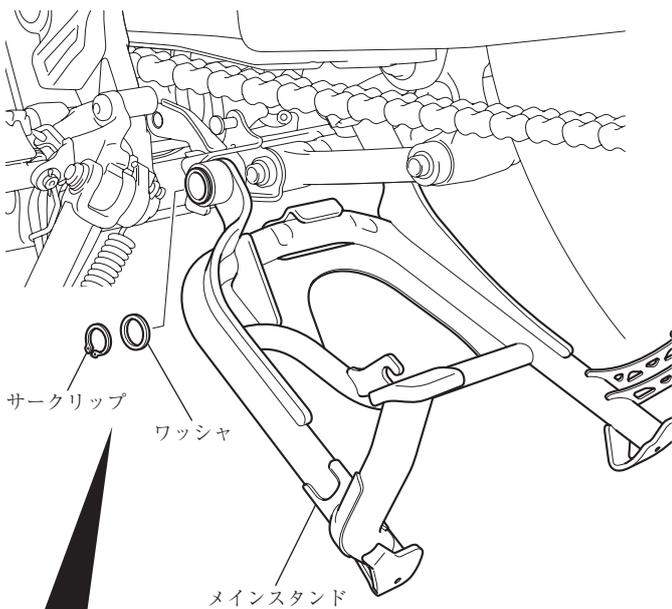
図の向きでサークリップを溝に取り付ける。
