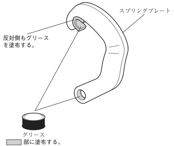
9) 図のようにスプリングをスプリングプレートに取り付ける。
