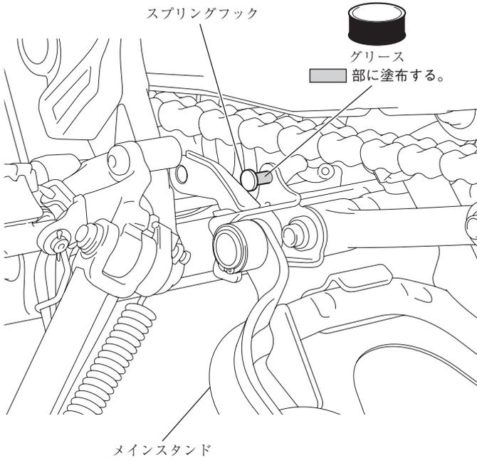
11) 図のようにスプリングプレートを取り付ける。
