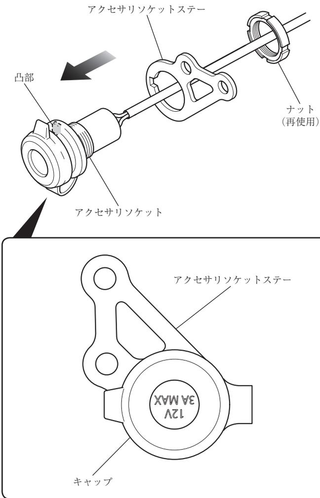
4) 図のようにアクセサリソケットのカバーを取り付ける。
